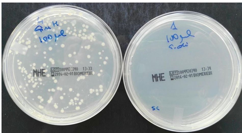
Figura 4. Crecimiento en las muestras tras la inoculación de Escherichia coli . Izquierda: muestra tomada antes del tratamiento. Derecha: muestra tomada después del tratamiento de higienización con luz ultravioleta con el equipo Corvent Sanidis®
